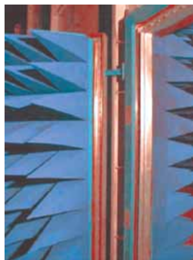
Fig. 12 Camera semianecoica: a) setup di prova, b) gasket in corrispondenza della porta di accesso
