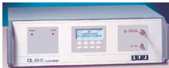
Fig. 6. Esempi di strumentazione per la misurazione della potenza irradiata e del click: a) pinza assorbente MDS 21 della Rhode&Schwartz, b) analizzatore di click CL55c della AFJ
