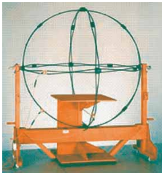
Fig. 5 Esempi di strumentazione per la misurazione delle emissioni da apparecchiature per l'illuminazione: a) two-Line V-Lisn ENV216, b) triple loop antenna HM020, c) analizzatore di spettro ESCI/ESC17 EMI test receiver, della Rhode&Schwartz
